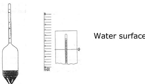
**NL****Salimeter / Zoutdichtheidsmeter voor zeewater**
